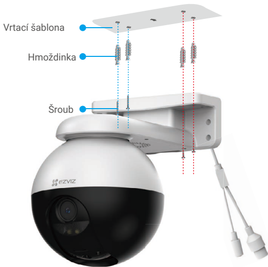
Obr. 1 Montáž na strop
